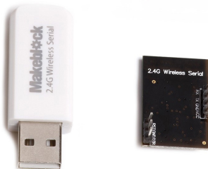
➔ Der USB Wireless Dongle verbindet sich mit dem Wirelessmodul auf dem Roboter
